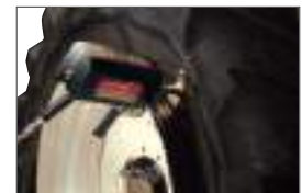
MF0-12300201 Pneumatischer Wulstab- drücker DM 120 für EM-Reifen
