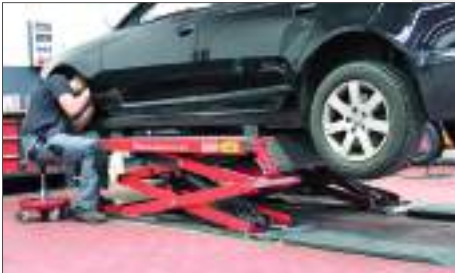
Doppel-Scherenhebebühne mit 3.500 kg Tragkraft.
