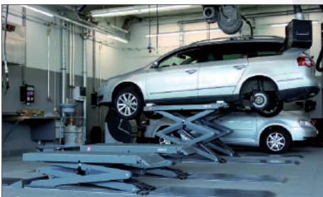
Optional: Lange Überfahrrampen für tiefergelegte Fahrzeuge (4 Stück, 40 mm hoch).
