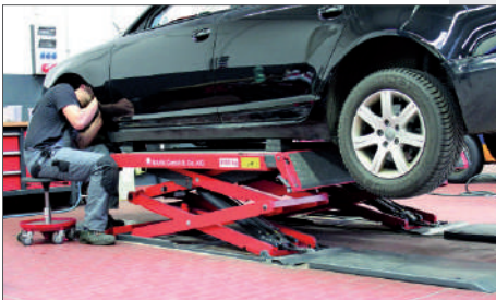
Doppel-Scherenhebebühne mit 3.500 kg Tragkraft.
