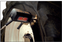
MF0-12300201 Pneumatischer Wulstab- drücker DM 120 für EM-Reifen
